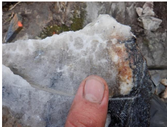
Figure 8 : Veine de quartz et feldspaths avec traces arsénopyrite. / Quartz feldspar vein with traces of of arsenopyrite..
