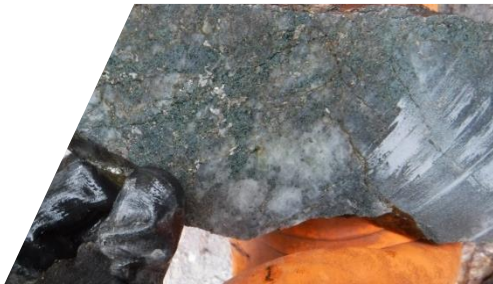
Figure 5 : Échantillon de rainurage montrant la minéralisation en pyrrhotite, arsénopyrite et pyrite dans une formation d'amphibolite/fer / Channel sample showing the mineralization in pyrrhotite, arsenopyrite and pyrite in an amphibolite/iron formation
