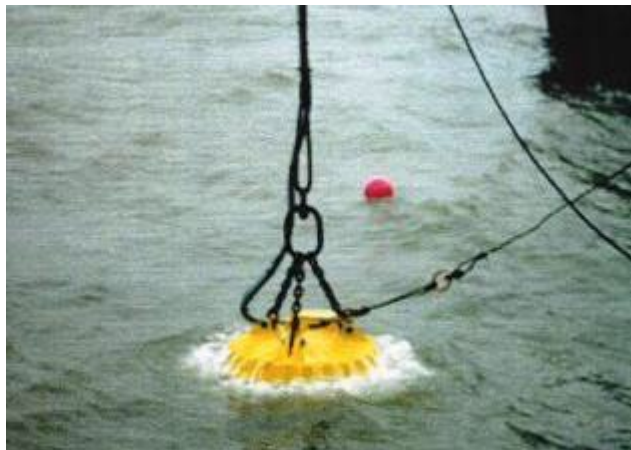
Figure 5: WOKO Magnet- und Anlagenbau GmbH, marine electromagnetic in operation.
