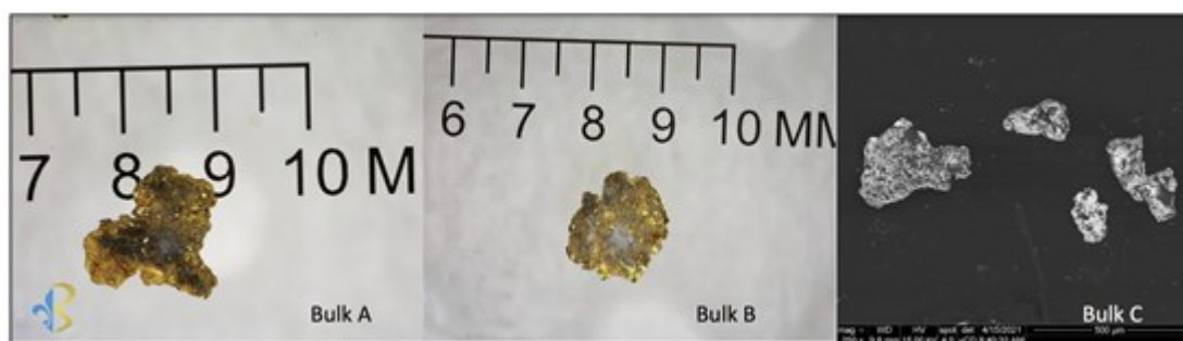
Figure 2: Photos des plus grosses particules d'or observées dans les échantillons en vrac. La photographie de l'échantillon Bulk C est une image provenant du MEB
