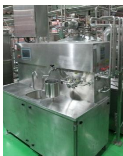
實驗型UHT設備 進行製樣
