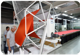
TPU布料或薄膜 由裁切機或沖床 依需求裁切及印刷
