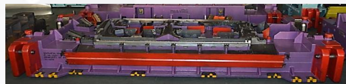
出口美國福特的F-150側圍模具(材質：鋁合金材質)
