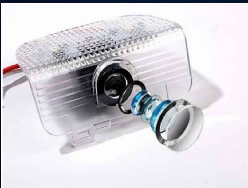
替換式安裝結構
