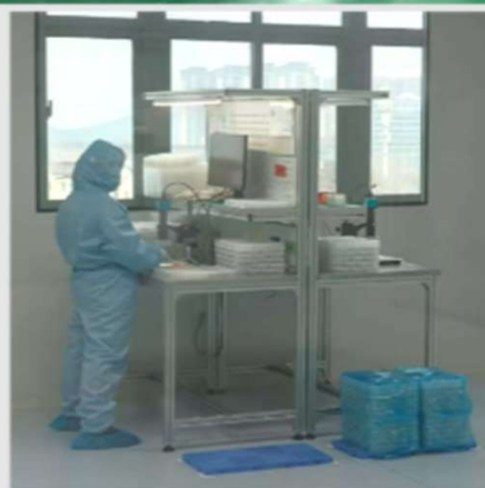
无尘室外观目视检验
