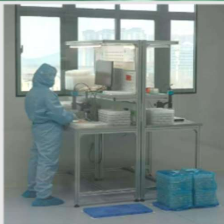
无尘室外观目视检验
