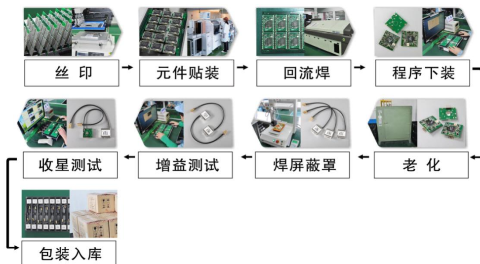
③LTCC元器件生产工艺流程
