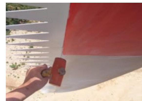
在风机叶片粘贴锯齿尾缘，降低噪声
