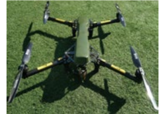
2016 年，公司推出无人机叶片诊断系统，克服了过去风电场运维过程中，在风机下使用望远镜观察或吊篮上塔的运维方式，大幅提升准确性及安全性
