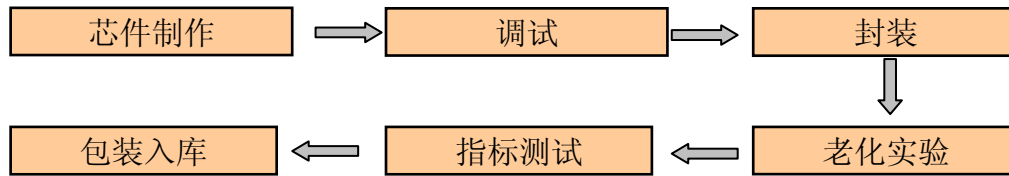
图 6-17 光隔离器工艺流程
