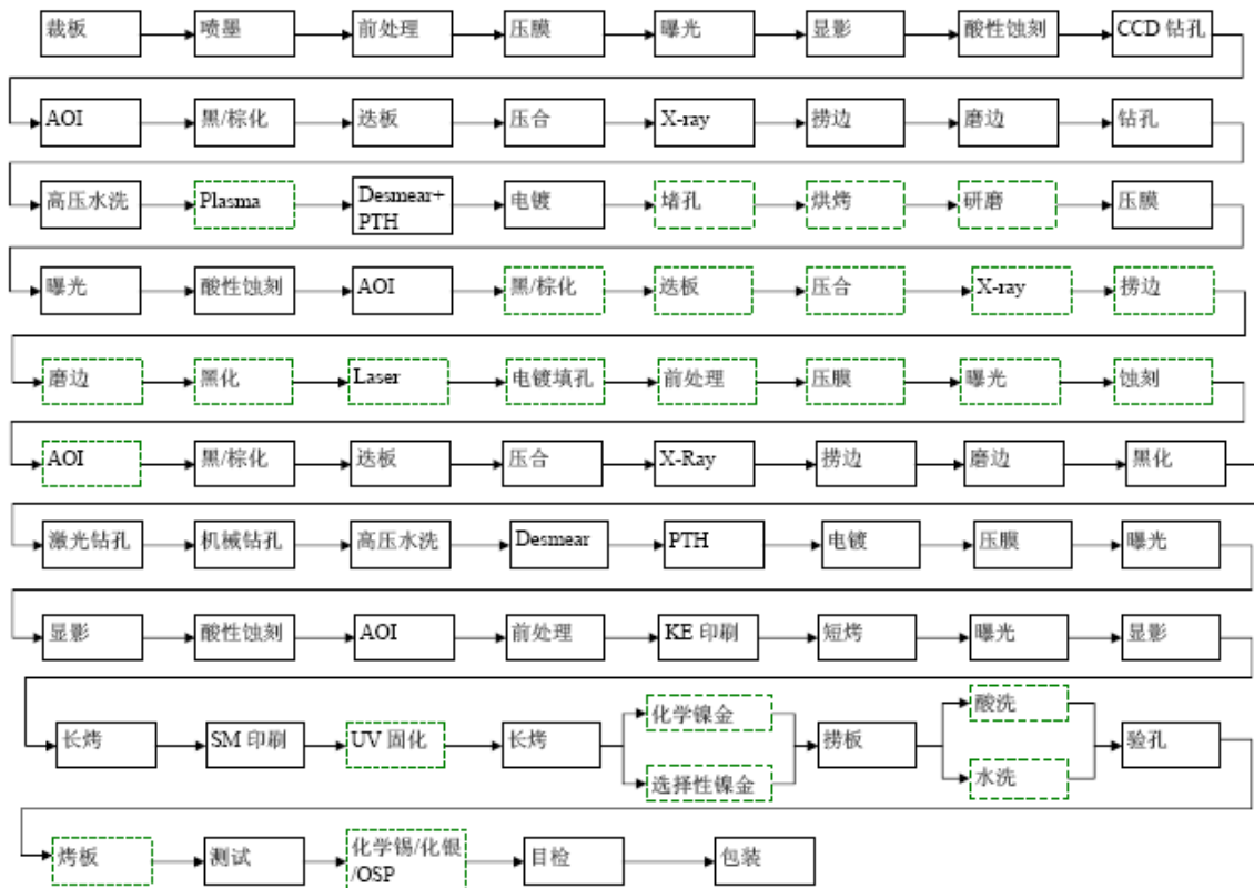
图 5-3 HDI 板生产典型流程图
