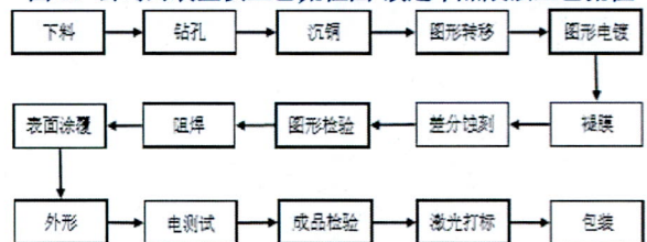
图 5：公司封装基板工艺流程图-改进半加成法工艺流程
