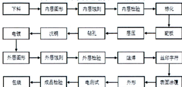
图 3：公司印制电路板工艺流程图
