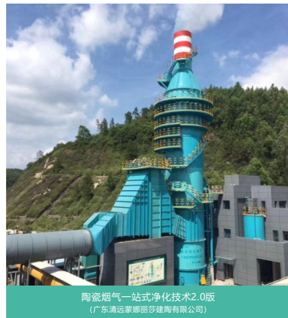
建筑陶瓷烟气一站式净化技术1.0版 (蒙娜丽莎集团股份有限公司)
