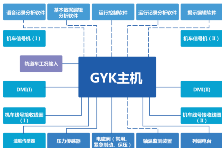
GYK 铁路轨道车运行控制产品结构图
