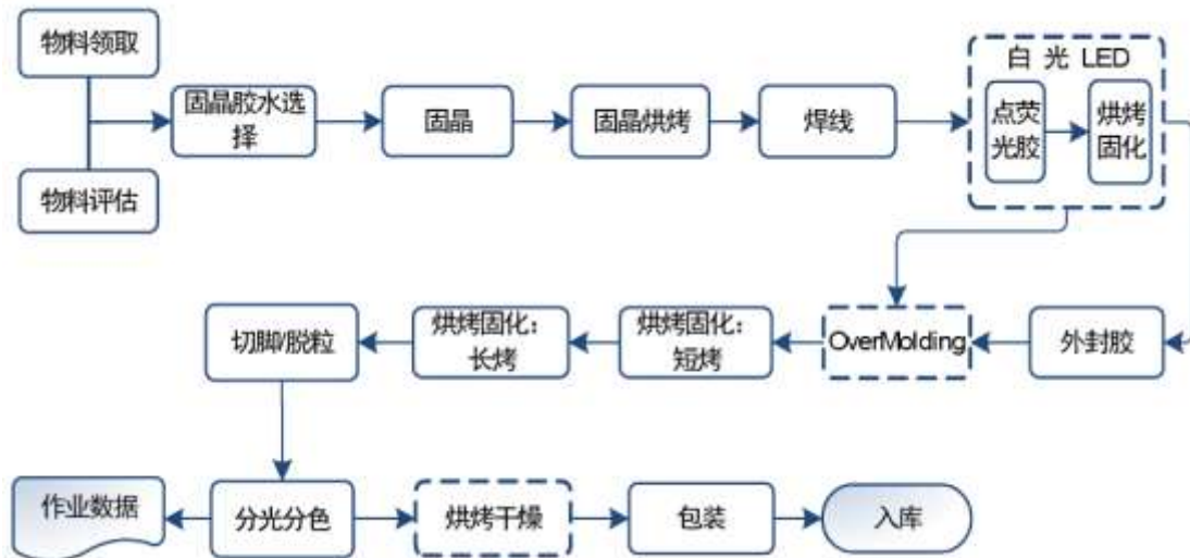
图表 9：LED 器件封装工艺流程图
