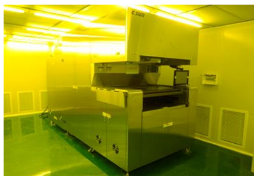
ITO &amp; 银浆 CCD 自动对位曝光机
