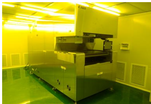
ITO &amp; 银浆 CCD 自动对位曝光机
