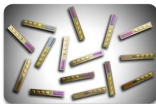
检测冠状动脉血压的压力传感器
