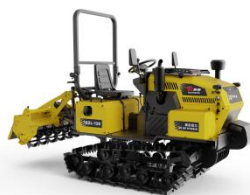
1GZL-130 50马力履带旋耕机
