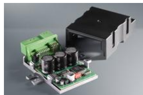
电子燃油泵控制
