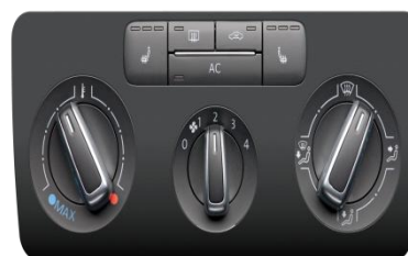
捷达 GOLF 汽车空调控制系统
