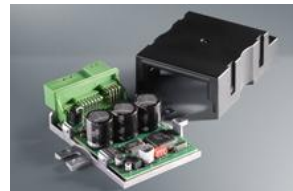
电子燃油泵控制
