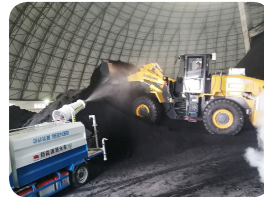
神渭管运公司储煤仓存煤喷淋抑尘降温
