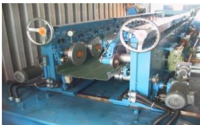
现场生产出料口
