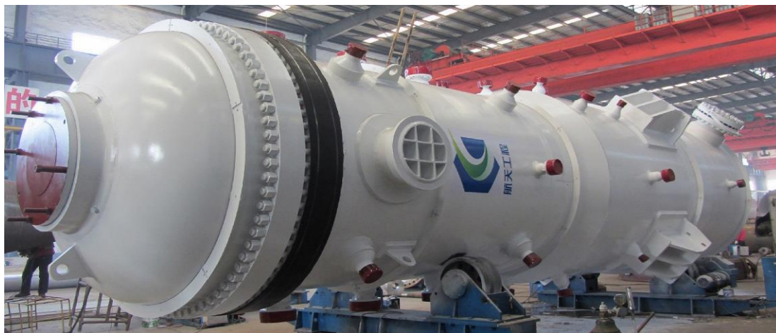
航天粉煤气化炉
