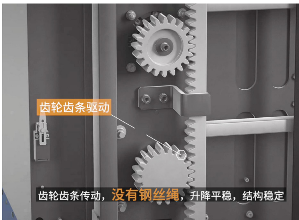
齿轮齿条传动示例
