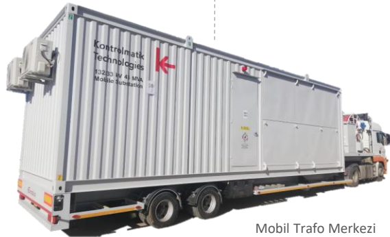
Mobil Trafo Merkezi
