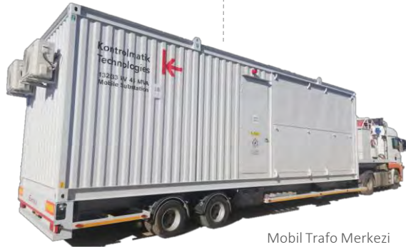
Mobil Trafo Merkezi
