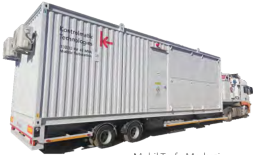
Mobil Trafo Merkezi
