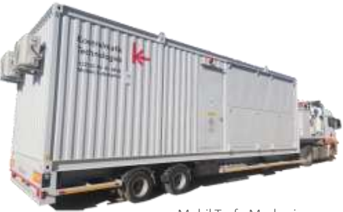
Mobil Trafo Merkezi
