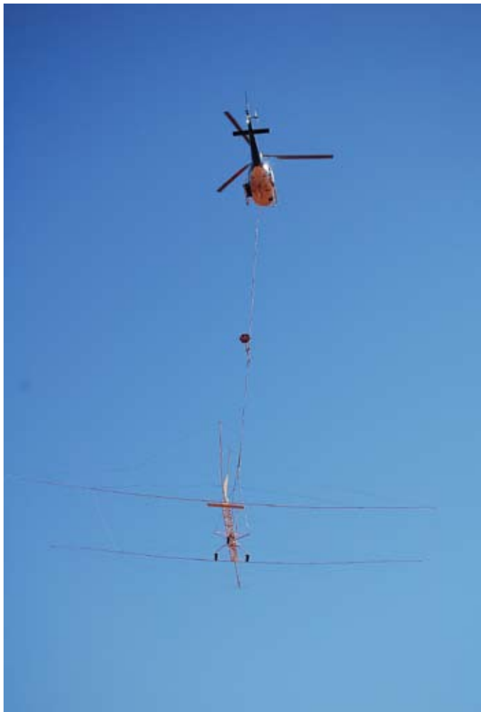
EM hoist used to fly the airborne EM survey over the Billa Kalina Project area.
