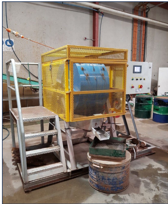
Figure 4. Drum Scrubber Set up at ALS Laboratory
