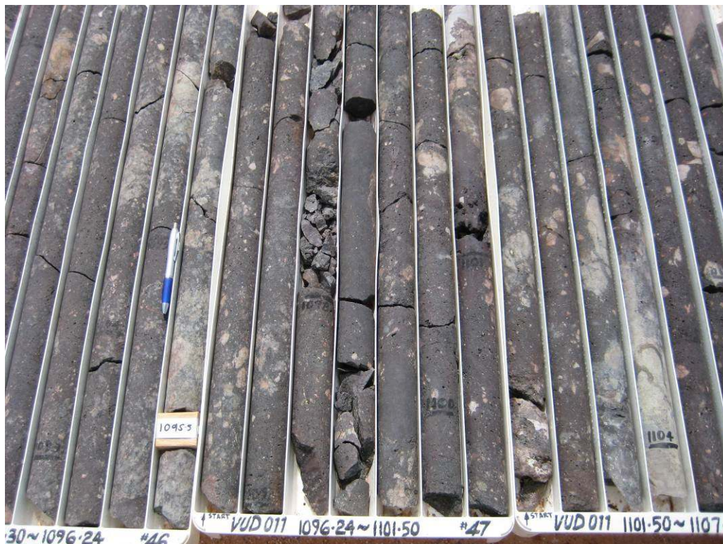
Figure 3a: VUD 11 1082-1106m, vughy hematite-rich breccia (NQ 2 drill core)
