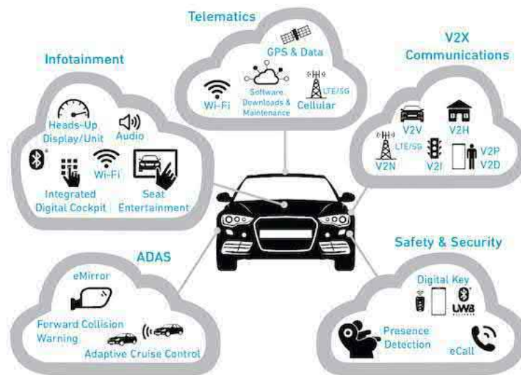
互聯汽車(connected car)示意圖
