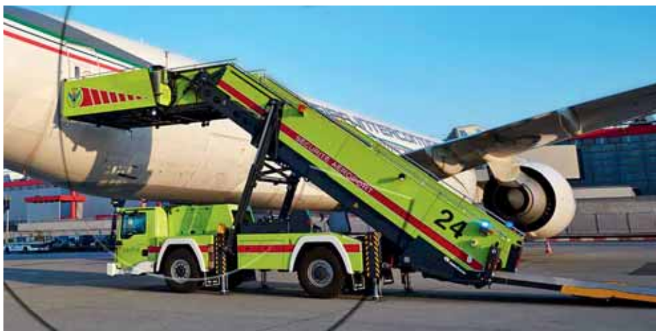
Ende 2014 erhielt der Flughafen Genf die neue Rettungstreppe E5000. Damit komplettiert Rosenbauer seine Flotte an Rettungstreppenfahrzeugen und deckt den Höhenbereich zwischen 2,5 und 5,5 m ab.
