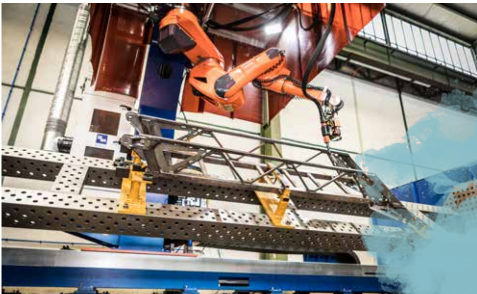
HÖCHSTE PRÄZISION BEI KOMPLEXEN ARBEITSSCHRITTEN Roboter schweißen den Leiterpark von Drehleitern zusammen.
