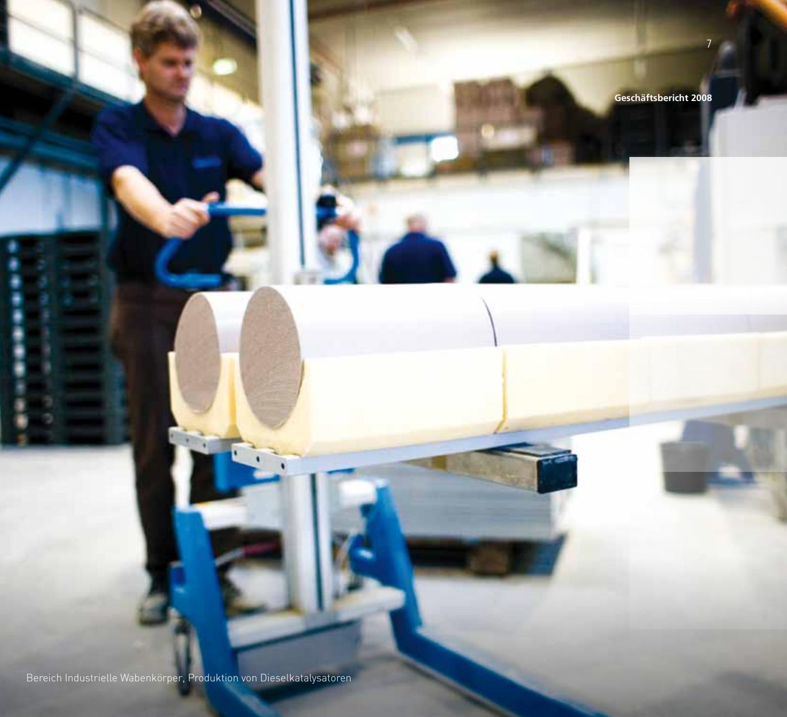
Bereich Industrielle Wabenkörper, Produktion von Dieselkatalysatoren
