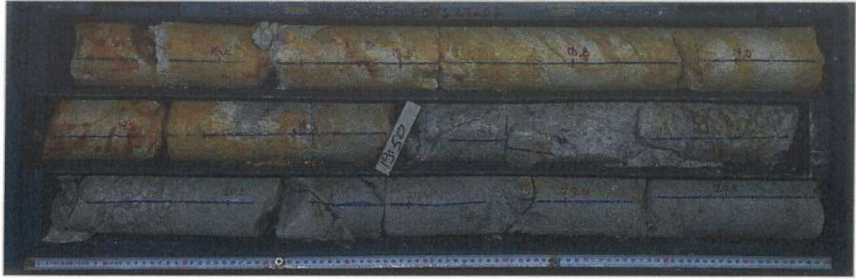
Şekil- 59. Karot İşaretleme – İşleme
