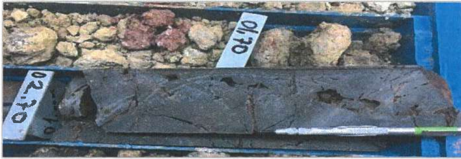
Şekil- 52. Oksitlenmiş Mineral Gösteren Karot Kutusu
