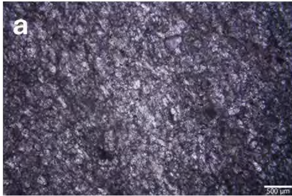
Şekil 72 17544 No' lu örneğine ait ince kesit fotoğrafları. Mikrogranoblastik dokuyu oluşturan kalsit ksenomorfalarının görünüşleri.
