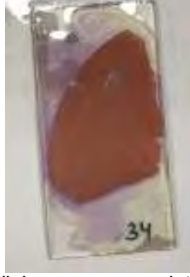
Şekil 70 17534 No' lu örneğin alizarin kırmızısı ile boyanması sonucunda tamamına yakınının boyandığı tespit edilmiştir.
