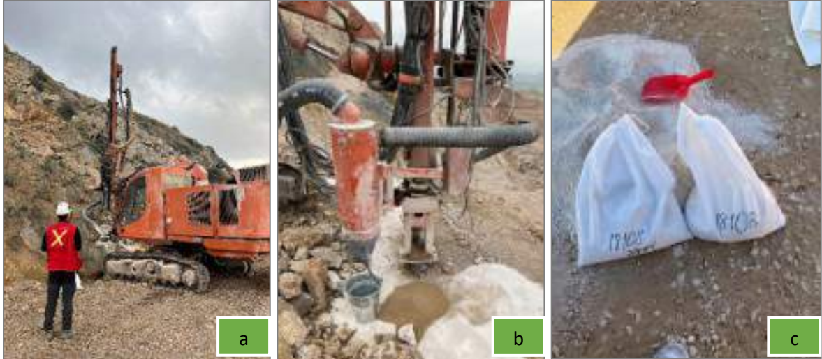
Şekil 49 Delici rok ile toz numune alma işlemleri (a, b, ve c).
