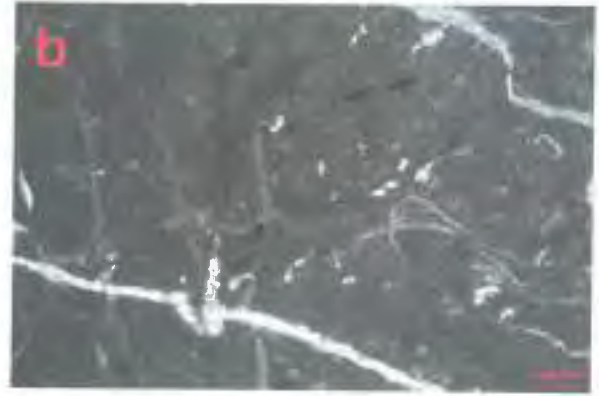
Şekil 7. 17508 nolu örneğine ait ince kesit fotoğrafları. Mikritik matris içerisindeki yuvarlağimsı biyoklastlar ile mikritik matrisi kesen kalsit ve demirli mikritlerin görünümü (a ve b).
