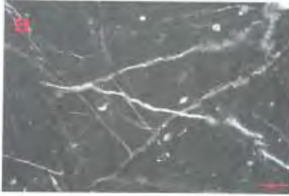
Şekil 7. 17508 nolu örneğine ait ince kesit fotoğrafları. Mikritik matris içerisindeki yuvarlağimsı biyoklastlar ile mikritik matrisi kesen kalsit ve demirli mikritlerin görünümü (a ve b).
