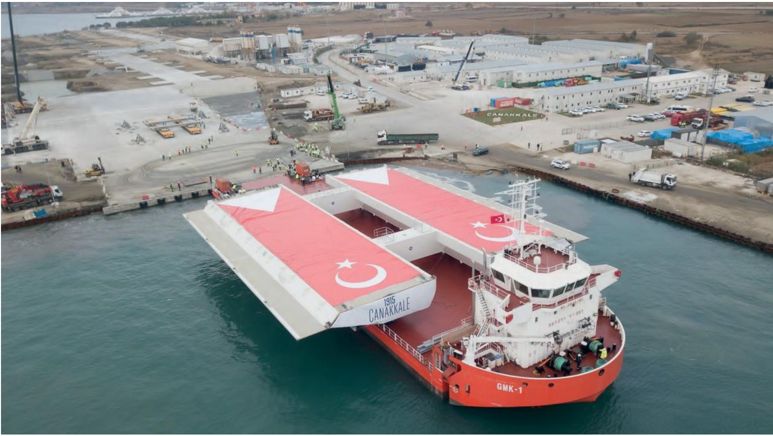
1915 Çanakkale Köprüsü Tabliyelerinin Taşınması Projesi
