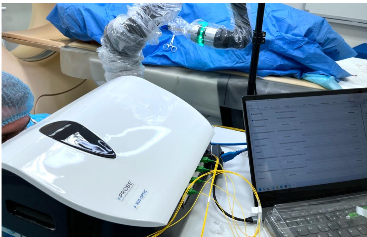
Zdjęcie 2. Wykonanie pomiaru molekularnego wskazanego markera nowotworowego przy wykorzystaniu technologii inPROBE.
